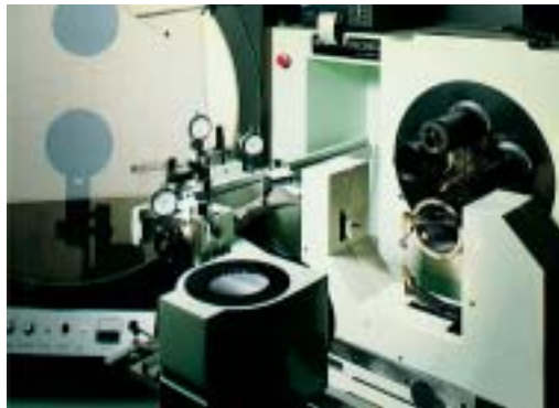
Dettaglio dell'apparecchiatura P-4N comprendente il dispositivo tastatore/ripetitore ed il supporto per il controllo di palette singole
